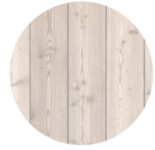
Bardage bois en pignon - mélèze brut
